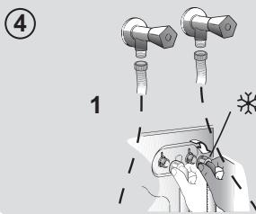
● **AQUASTOP** (obr. 5): zariadenie umiestnené na prívodnej hadici, ktoré zastaví prívod vody v prípade poškodenia hadice; v tomto prípade sa zobrazí červený symbol v okienku "A" a hadicu musíte vymeniť. K odskrutkovaniu matice stlačte jednosmerné poistné zariadenie "B".
