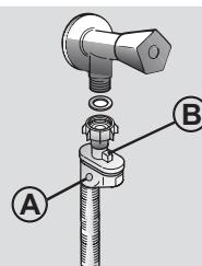
● **AQUAPROTECT - PRÍVODNÁ HADICA S OCHRANOU** (obr. 6): Ak voda pretečie z hlavnej internej hadice "A", transparentný izolačný plášť "B" udrží vodu na dokončenie pracieho cyklu. Na konci cyklu kontaktujte autorizované servisné stredisko pre výmenu prívodnej hadice.
