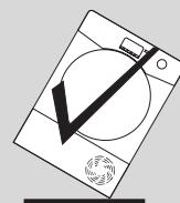
Ukoliko je uređaj bio okrenut na drugačiji način, pričekajte barem 4 sata prije uključenja, kako bi se ulje vratio u kompresor i stabiliziralo. U suprotnom, može doći do oštećenja kompresora.
