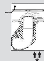
\* Izlazni ventil za zrak (ovisno o modelu).
