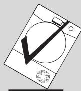
**Ukoliko je uređaj bio okrenut na drugačiji način, pričekajte barem 4 sata prije uključenja, kako bi se ulje vratilo u kompresor i stabiliziralo. U suprotnom, može doći do oštećenja kompresora.**
