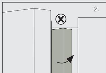
Pokud se pokusíte zavřít levé dveře a vertikální pás na dveřích není zahnutý (2), nejprve ho zahněte, jinak pás na dveřích zasáhne upevňovací hřídel nebo pravé dveře. Tak může dojít k skluzu nebo netěsnosti dveří.
