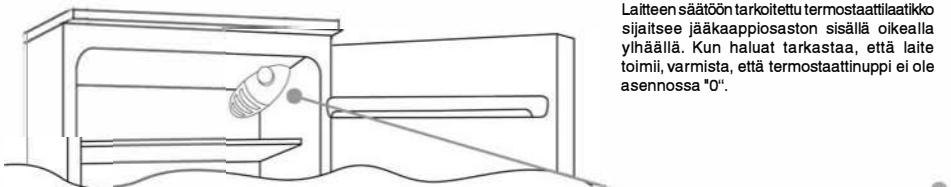
Laitteen säätöön tarkoitettu termostaattilaatikko sijaitsee jäätäkappiosaston sisällä oikealla ylhäällä. Kun haluat tarkastaa, että laite toimii, varmista, että termostaatinpippi ei ole asennossa "0".
