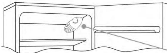
Termostat v hladilnem delu desno zgoraj omogoča upravljanje aparata. Aparat deluje, če gumb termostata ni obrnjen na 0 °.
