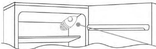
Gumb termostata za kontrolu temperature uređaja nalazi se u unutarnjem prostoru hladnjaka s gornje desne strane. Da provjerite da li uređaj funkcioniра, budite sigurni da gumb termostata nije postavljen na položaj "0".
