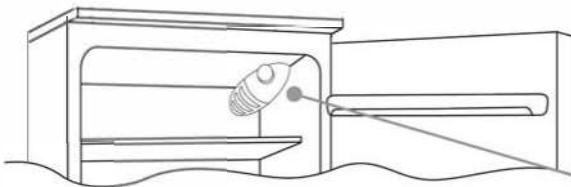
Termostatboxen för att kontrollera apparaten är placerad inuti kylskäpsutrymmet uppe till höger. För att kontrollera om apparaten fungerar, säkerställ att termostatvredet inte är inställt på „0“.
