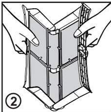
3. Entfernen Sie die Flusen sanft mit einer weichen Bürste oder den Fingerspitzen.,
