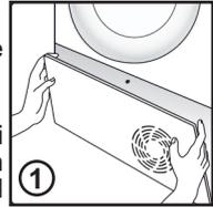
2. Drehen Sie die zwei Verschlusshebel gegen den Uhrzeigersinn und ziehen Sie den Kondensatordeckel heraus
