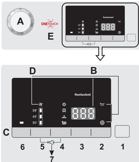
**A-Auswahlanzeige** - Der Knopf kann in beide Richtungen gedreht und damit das gewünschte Trocknungsprogramm ausgewählt werden. Drehen Sie den Knopf zum Ausschalten des Trockners oder zum Löschen auf AUS (OFF).
