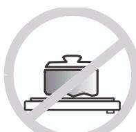
Non collocare recipienti ruvidi o irregolari sul piano di cottura, poiché potrebbero danneggiare la superficie ceramica.
