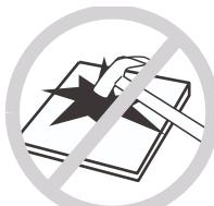
Ak je povrch varnej dosky prasknutý, vypnite zariadenie, aby ste zabránili možnosti úrazu elektrickým prúdom.
