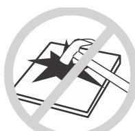
Se la superficie del piano di cottura presenta crepe, spegnere l'elettrodomestico per evitare la possibilità di elettrocuzioni.
