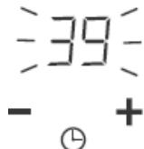
Allo scadere del periodo di tempo impostato nel timer, la zona di cottura corrispondente si spegnerà automaticamente.
