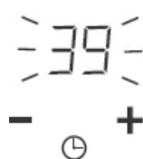
Po uplynutí nastaveného času se příslušná varná zóna automaticky vypne.
