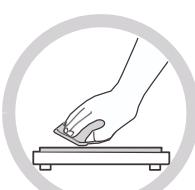
Pulire regolarmente il piano di cottura a induzione per evitare che corpi estranei penetrino nel ventilatore e impediscano il corretto funzionamento dell'elettrodomestico.
