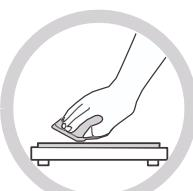
Indukční varnou desku pravidelně očistěte, abyste zabránili vnikání cizích předmětů do ventilátoru, a tak zabráníte nesprávnému fungování zařízení.
