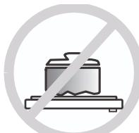
Na varnú dosku neukladajte nádoby s drsným alebo nerovným povrchom, lebo by mohli poškodiť keramický povrch.
