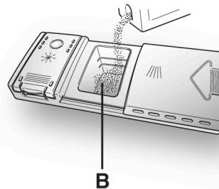
Po włożeniu detergentu do pojemnika zamknąć pokrywę najpierw przesuwając ją a potem przyciskając lekko aż do usłyszenia dźwięku zamknięcia.
