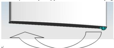
6. Przełożyć zawias dolny na drugą stronę i zamontować za pomocą śrub.
