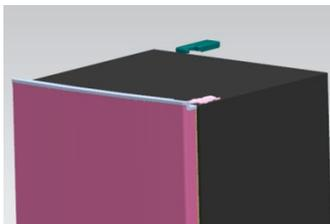
2. Bruk en kryssporskrutrekker for å fjerne skruene i det faste topphengelet.
