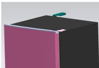
2. Demontujte šrouby zašroubované v horním závěsu pomocí křížového šroubováku.
