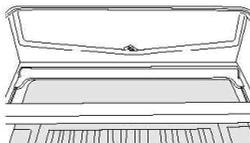
Det er satt en «rengjøringsspiker» i dreneringshullet. Denne skal hindre at små matbiter havner i dreneringssystemet. Når du har rengjort kjøleskapet innvendig og fjernet eventuelle matrester rundt dreneringshullet, bruker du «rengjøringsspikeren» for å sikre at det ikke finnes blokkeringer. Utsiden av kjøleskapet/fryseren rengjøres med vanlig møbelpuss. Pass på at dørene er lukket, slik at det ikke kommer møbelpuss på innsiden eller den magnetiske dørforseglingen.
