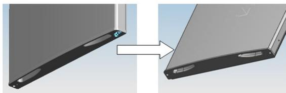
C. Odvijte vijak in odstranite še drug omejevalnik odpiranja vrat.
