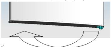
6. Mutați balamaua de jos pe partea opusă a ușii și fixați-o cu șuruburi.
