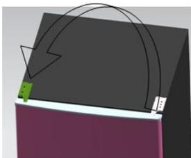
10. Sett øvre dør i høyreposisjon og fest topphengselet og dekkelet.
