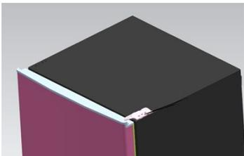
3. Udskift det øverste hængsel og den øverste dørbeholdningsblok, og dørens lejebøsning på den anden side.
