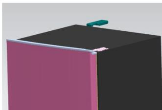
2. Retirez les vis de fixation de la charnière supérieure à l'aide d'un tournevis cruciforme.
