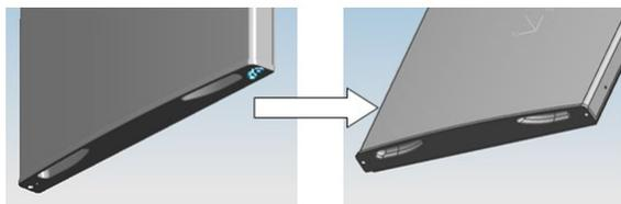
C. Vyměňte další dveřní blok, který je šroubem připevněn ke dveřím.
