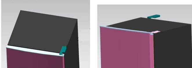
2. Îndepărtați șuruburile care fixează balamaua folosind o șurubelniță cu cap în cruce.
