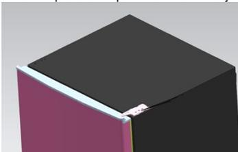
3. Passe a dobradiça superior e o bloco limite superior da porta, juntamente com a bucha do rolamento para a porta oposta.
