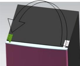
10. Nastavte horné dvere do správnej polohy, upevnite horný záves a kryt.
