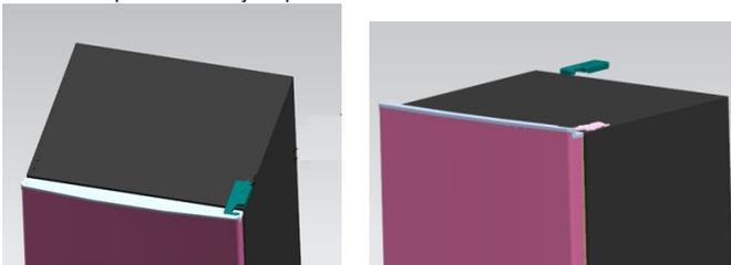
2. Retire os parafusos que fixam a dobradiça superior com a chave de fendas cruzada.
