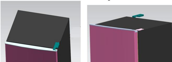
2. Entfernen Sie die Befestigungsschrauben des oberen Scharniers mit einem Kreuzschlitz-Schraubendreher.
