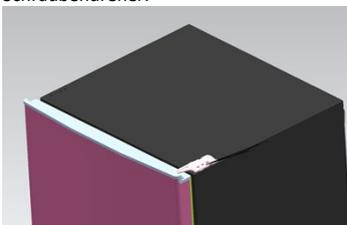
3. Tauschen Sie das obere Scharnier, den oberen Türanschlagblock sowie die Tür Lagerbuchse auf die gegenüberliegende Seite.
