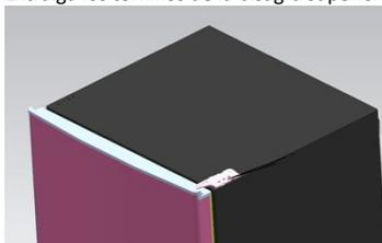
3. Coloque la bisagra superior junto con el tope de la puerta superior y el casquillo de cojinete de la puerta en el otro lado.
