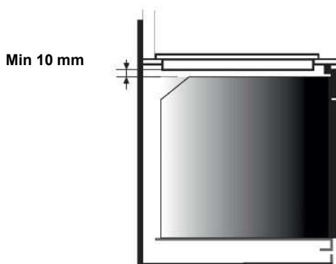
Spishällen levereras med en vattentät tätningspackning. Montera tätningspackning runt den nedre spishällen enligt beskrivningen och se till att den är ordentligt monterad för att undvika läckage i möblerna.
