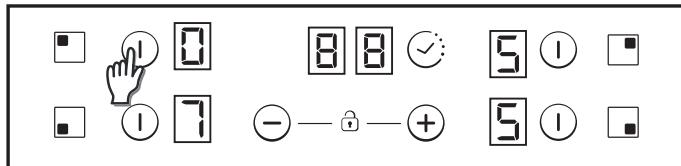
Si une seule zone de commande est allumée, celle-ci est sélectionnée par défaut, sans qu'il soit nécessaire d'exercer une pression (de 150 ms) sur la touche de commande.
