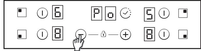
5 - Met behulp van de 'Plus'- en 'Min'-toetsen kan de waarde van het vermogenbeheer worden aangepast. In onderstaand voorbeeld tussen 6500 en 2500 W. Wanneer de vereiste waarde is geselecteerd, raakt u de 'Plus'- en 'Min'-toetsen tegelijk gedurende 5 seconden aan.
