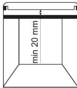
Vid installation av en ugn under spishällens får avdelare inte placeras och det minsta avståndet mellan spishällens undre del och ugnen får inte vara mindre än 10 mm. Installera inte kylugn under den här spishällens och installera ugnen enligt dess installationskrav.
