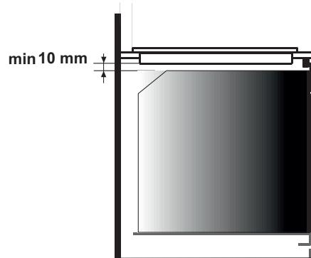
Zum Lieferumfang des Kochfelds gehört eine wasserundurchlässige Abdichtung. Bringen Sie die Abdichtung wie beschrieben um das Unterteil herum an und achten Sie darauf, dass sie korrekt sitzt, damit keine Flüssigkeiten in die tragenden Möbelstücke eindringen können.
