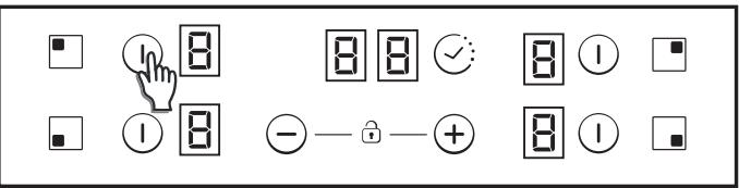
Per accendere una zona di riscaldamento toccare una qualsiasi zona di riscaldamento per 400 msec. Si sentirà un bip prolungato ed il valore "0" verrà visualizzato nella cifra della zona di destinazione, indicando il livello di potenza.
