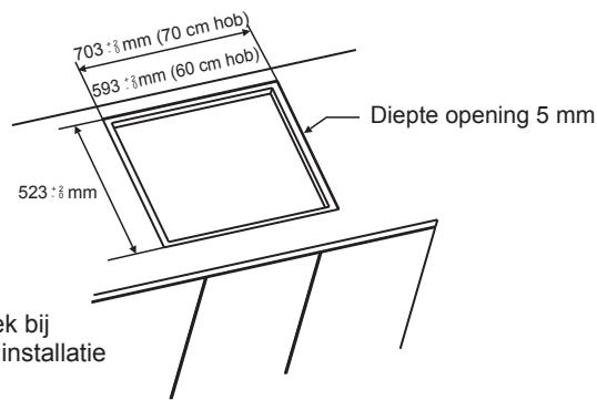
**Opmerking:** De afmetingen van de binnenste omtrek zijn hetzelfde bij de standaard installatie
