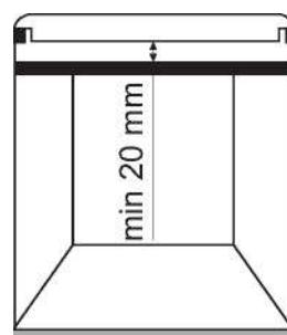
Når der installeres en ovn under kogesektionen, skal der ikke opsættes en skilleplade, og minimumsafstanden mellem kogesektionens bund og ovnen må ikke være mindre end 10 mm. Installér ikke ovne uden køling under kogesektionen og installér ovnen iht. dens egne installationskrav.
