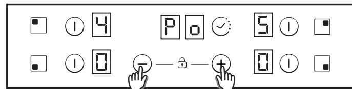
6 - Sobald der Vorgang abgeschlossen ist, ertönt ein langer Piepton und eine Zurücksetzung erfolgt. Der Start-Vorgang wird erneut ausgeführt.
