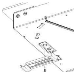
Sätt in spishällen i mittläge för utskjutning. Vrid klämmorna och dra åt dem helt.
