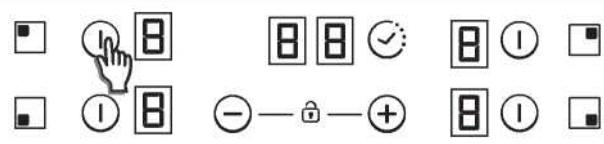
For å slå **PÅ** en varmesone tar du på varmesonens felt i 400 msec. Det høres en lang pipelyd og verdien "0" vil dukke opp i målsonens felt, for å indikere effektnivået.
