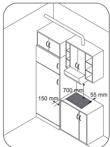
Sousedí-li spodní část varné desky s oblastí, která je běžně přístupná pro manipulaci nebo čištění, je nutné umístit pod spodní část varné desky oddělovač o tloušťce 20 mm.
