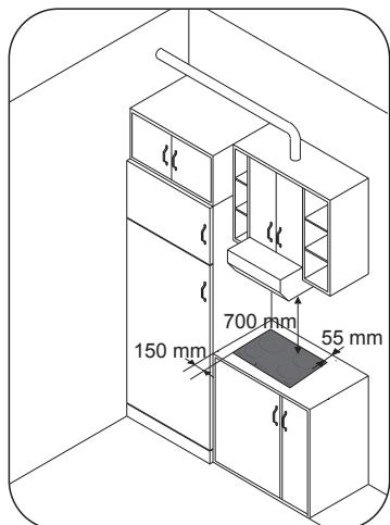
Als het onderste gedeelte van de kookplaat aan een ruimte grenst die normaal toegankelijk is voor opbergen of schoonmaken, dan moet er een scheidingspaneel worden aangebracht op 20 mm onder het onderste gedeelte van de kookplaat
