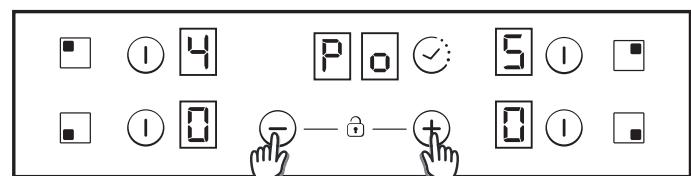
6 - Wanneer dit proces is voltooid, weerklinkt een lange piep en wordt een reset uitgevoerd. Het opstartproces wordt opnieuw gegenereerd.
