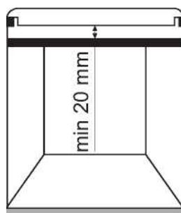
Ved installasjon av en ovn under platetoppen skal det ikke settes inn en separator, og minimumsavstanden mellom den nederste delen av platetoppen og ovnen må ikke være mindre enn 10 mm. Ikke installer en ikke avkjølt ovn under denne platetoppen og installer ovnen i henhold til sine egne installasjonskrav.
