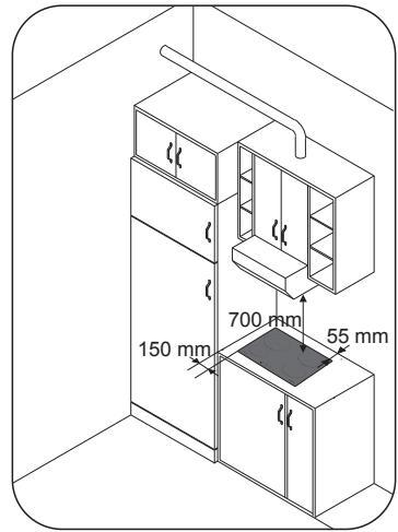
Falls die untere Fläche des Kochfelds an einen Bereich grenzt, der beim Hantieren oder Reinigen normalerweise zugänglich ist, ist unter dem Unterteil des Kochfelds eine Abtrennung von 20 mm vorzusehen.
