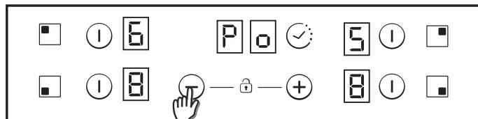
5 - Pomocí tlačítka „Plus“ a „Mínus“ lze upravovat hodnotu řízení výkonu. V tomto příkladu se jedná o hodnotu mezi 6500 a 2500 W. Až vyberete požadovanou hodnotu, na 5 sekund současně stiskněte tlačítka „Plus“ a „Mínus“.
