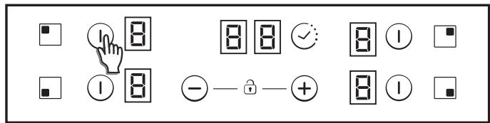
Pour allumer un foyer de cuisson, touchez la zone de commande correspondante pendant 400 ms. Un long bip retentit et le chiffre « 0 » s'affiche pour cette zone, indiquant le niveau de chauffe.
