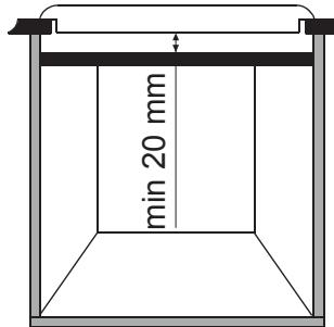
Falls unter dem Kochfeld ein Ofen installiert wird, darf die Abtrennung nicht angebracht werden, und der Mindestabstand zwischen dem unteren Teil des Kochfelds und dem Ofen darf nicht kleiner als 10 mm sein. Unter diesem Kochfeld darf kein ungekühlter Ofen installiert werden. Bei der Montage sind die Installationsanforderungen des Ofens zu berücksichtigen.
