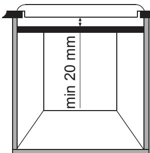
Wanneer u een oven onder de kookplaat installeert, dan moet er geen scheidingspaneel worden aangebracht en mag de minimale afstand tussen het onderste gedeelte van de kookplaat en de oven niet minder zijn dan 10 mm. Installeer geen warme oven onder deze kookplaat en installeer de oven volgens de bijgeleverde installatievereisten van de oven.
