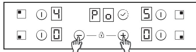
6 - Po dokončení tohoto postupu se ozve dlouhé pípnutí a provede se reset. Znovu se aktivuje spouštěcí postup.
