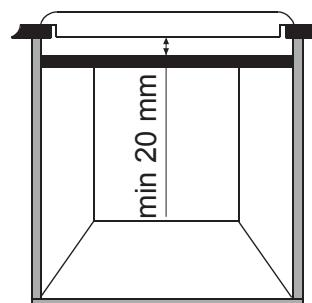
Při instalaci trouby pod varnou desku nelze oddělovač použít a minimální vzdálenost mezi spodní částí varné desky a troubou nesmí být kratší než 10 mm. Neinstalujte pod tuto varnou desku troubu bez chlazení. Troubu nainstalujte podle jejich vlastních požadavků na instalaci.
