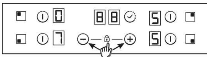
Når kogepladen allerede er tændt, produceres der en lavere lysintensitet for de ikke valgte kogeplader som er tændt.
