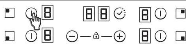
För att slå PÅ en värmeplatta trycker du på någon av värmezonerna i 400 msec. Ett långt pipljud hörs och siffran "0" visas i målzonern, vilket indikerar effektnivån.
