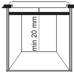
L'installation d'un four au-dessous de la table de cuisson ne requiert pas de panneau de séparation, mais la distance minimum entre la partie inférieure de la table de cuisson et le four doit être de 10 mm. Seul un four avec système de refroidissement peut être installé sous la table de cuisson, selon ses propres consignes d'installation.
