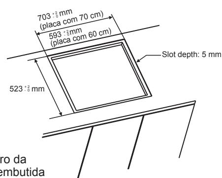
**Nota:** As dimensões do perímetro interior são as mesmas para a instalação padrão
