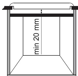
Não deve colocar um separador se instalar um forno por baixo da placa, e a distância mínima entre a parte inferior da placa e o forno não deve ser inferior a 10 mm. Não instale fornos sem arrefecimento debaixo desta placa e instale o forno cumprindometiculosamente os requisitos de instalação do mesmo.
