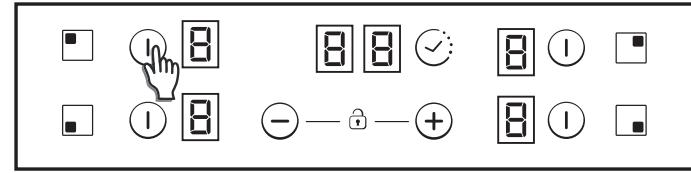
Een kookzone **INSCHAKelen**: Raak een kookzone aan gedurende 400 msec. Er klinkt een lange piep en de waarde "0" verschijnt in de doelzone, wat het vermogen aangeeft.
