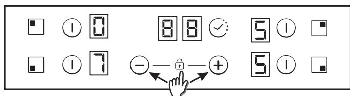
Durch einen kurzen Druck auf die Taste „+“ oder „-“ erhöhen bzw. verringern Sie die Leistungsstufe der gewählten Kochzone schrittweise: 0-1-2-3...9-P
