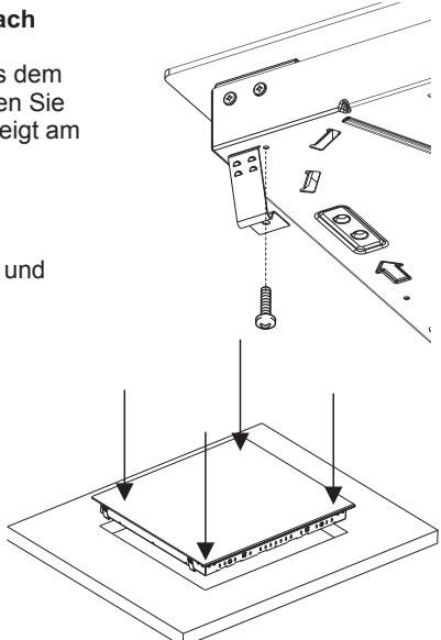
**FLÄCHENBÜNDIGE INSTALLATION** Nachdem Sie überprüft haben, dass das Kochfeld korrekt positioniert ist, füllen Sie den Spalt zwischen Arbeitsplatte und Kochfeld mit Silikonkleber. Glätten Sie die Silikonschicht mit einem Schaber oder einem Finger und etwas Seifenlauge, bevor es aushärtet. Benutzen Sie das Kochfeld erst, wenn die Silikonschicht ausgehärtet ist.
