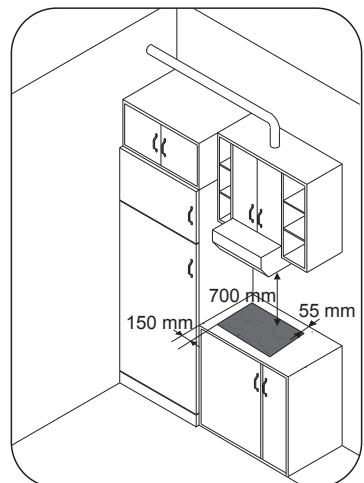
Se la parte inferiore del piano di cottura è adiacente ad un'area normalmente accessibile durante la cottura o la pulizia, inserire un separatore 20 mm sotto alla base del piano di cottura.
