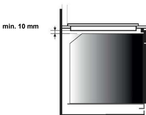
Der følger en vandtæt tætningsliste med kogesektionen. Montér tætningslisten rundt langs kogesektionens bund som beskrevet og sørge for at den er korrekt monteret for at undgå lækage ind i møblelet, den er monteret i.
