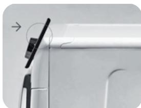
Si vous ne savez pas où se situe l'antenne NFC sur votre smartphone, faites de lents mouvements circulaires autour du logo Smart Touch jusqu'à ce que l'application Simply-Fi confirme la connexion. Afin de garantir une connexion stable, il est important de **GARDER LE SMARTPHONE SUR LE LOGO Smart Touch PENDANT LA PROCÉDURE D'APPAIRAGE ET PENDANT LE PHASE DE SYNCHRONISATION.** L'application Simply-Fi vous avertira lorsque vous pourrez retirer votre smartphone du logo Smart Touch.
