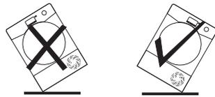
**ATTENTION:** Si le produit est transporté différemment, attendez au moins 4 heures avant d'allumer l'appareil, ceci afin que le gaz liquide retourne dans le compresseur. En cas de non respect de cette procédure, le compresseur pourrait être endommagé.
