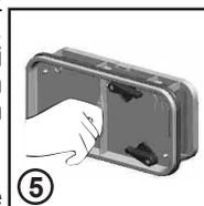
6. Setzen Sie die Wartungsklappe wieder ein.
