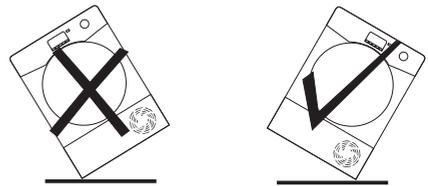
**Achtung:** Wenn das Gerät in eine andere Lage transportiert wurde, warten Sie mindestens 4 Stunden, bevor Sie es einschalten, damit sich die Flüssigkeit im Kompressor wieder stabilisieren kann. Tun Sie es nicht, können Schäden am Kompressor die Folge sein.
