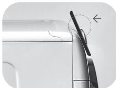
Pokud neznáte pozici **NFC** antény, krouživými pohyby lehce pohybujte chytrým telefonem nad logem **SMART Fi+** dokud aplikace nepotvrdí připojení. Aby byl přenos dat úspěšný, je nutné **UDRŽOVAT CHYTRÝ TELEFON V BLÍZKOSTI OVLÁDACÍHO PANELU BĚHEM CELÉHO NĚKOLIKVTEŘINOVÉHO PŘIPOJENÍ**. Následně Vás bude zařízení informovat o správném výsledku operace a oznámí Vám, že je možné přesunout se s chytrým telefonem kamkoliv.
