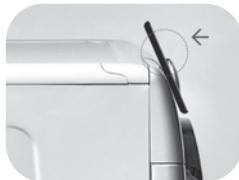
V prípade že nepoznáte pozíciu **NFC** antény, krúživými pohybmi ľahko pohybujte smart telefónom nad logom **SMART Fi+** až kým aplikácia nepotvrdí pripojenie. Aby bol prenos dát úspešný, **JE NUTNÉ UDRŽIAVAŤ SMART TELEFÓN V BLÍZKOSTI OVLÁDACIEHO PANELU POČAS CELÉHO NIEKOĽKOSEKUNDOVÉHO PRIPOJENIA**. Následne Vás bude zariadenie informovať o správnom výsledku operácie a oznámi Vám, že je možné presunúť sa so smart telefónom kamkoľvek.
