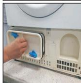
4. Entfernen Sie etwaigen Staub oder Flusen vorsichtig mit einem Tuch, reinigen Sie das Teil danach unter laufendem Wasser, wobei Sie es so drehen, dass das Wasser zur Entfernung von Staub und Flusen zwischen die Platten laufen kann.
