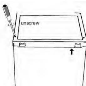
2. Heben Sie die obere Abdeckung 5 cm vom Gefrierschrank. Ziehen Sie dann die Anschlüsse raus. Entfernen Sie die obere Abdeckung.
