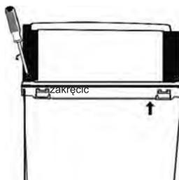
10. Zamknąć drzwi urządzenia. Przed dokręceniem śrub dolnego zawiasu upewnić się, że drzwi są dobrze wyregulowane (w poziomie i pionie) oraz uszczelka dobrze przylega do urządzenia na całej długości. Wypoziomować urządzenie za pomocą regulowanych nóżek.
