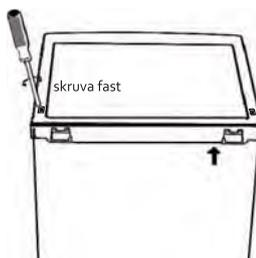
10. Släng dörren och kontrollera att den passar vågrätt och lodrätt och att tätningarna sitter tätt på alla sidor innan du fäster det nedre gångjärnet. Justera om nivåfötterna om det behövs.
