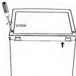
10. Bei geschlossener Tür, stellen Sie sicher bevor Sie, die oberen Scharniere festziehen, dass die Tür horizontal und vertikal ausgerichtet ist, so dass die Dichtungen an allen Seiten geschlossen sind. Passen Sie die verstellbaren FüÙe in die gewünschte Position an.
