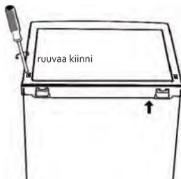
10. Ennen alasaranan ruuvien kiristämistä sulje ovi ja tarkista, että se on suorassa sekä vaaka- että pystysuunnassa ja että tiivisteet sulkevat oven kaikilta sivuilta. Säädä jalkojen korkeutta tarvittaessa uudelleen.
