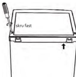
10. Sørg for at døren er på samme nivå horisontalt og vertikalt slik at forseglingene er lukket på alle sider før du til slutt strammer det nederste hengselet. Juster føttene på nytt ved behov.
