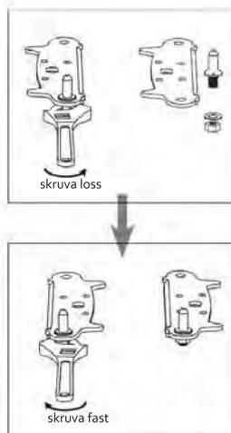
6. Sätt tillbaka haken så att den passar vågrätt och lodrätt så att tätningen sitter tätt längs alla sidor innan du fäster det övre gångjärnet.
