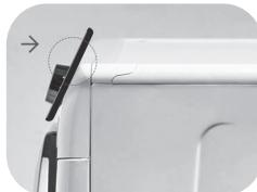
Pokud neznáte polohu antény NFC, pohybujte pomalu krouživými pohyby chytrým telefonem nad logem ONE Fi EXTRA do té doby, než aplikace potvrdí připojení. Aby byl přenos dat úspěšný, je důležité V PRŮBĚHU TĚCHTO NĚKOLIKA SEKUND DRŽET TELEFON NA OVLÁDACÍM PANELU; o správném průběhu této operace vás bude informovat zpráva na zařízení a řekne vám, kdy můžete odebrat chytrý telefon od panelu.
